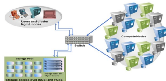
شکل ۱. ساختار یک مرکز پردازش سریع
